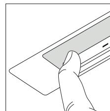
**!** Se a botoeira está completamente inativa, antes de contactar o Serviço de Assistência Técnica, seccionar temporariamente (cerca 5") a alimentação elétrica ao eletrodoméstico, possivelmente agindo no interruptor geral, para restaurar o funcionamento normal.
