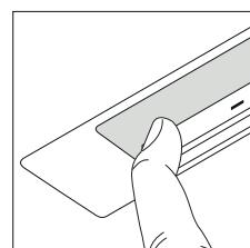
! Si el panel de mandos está totalmente inactivo, antes de contactar con el servicio de asistencia técnica, corte temporalmente (unos 5") la alimentación eléctrica al electrodoméstico, en lo posible, a través del interruptor general, para restablecer el funcionamiento normal. Si este procedimiento no resulta eficaz, póngase en contacto con el servicio de asistencia técnica.
