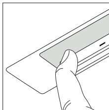
⚠ Om tryckknappspanelen är helt inaktiv ska du koppla bort strömförsörjningen till den elektriska apparaten tillfälligt (cirka 5 sekunder), om möjligt med huvudströmbrytaren, för att återställa normal drift innan du kontaktar teknisk service.
