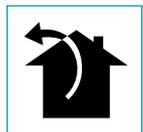
Nesta versão, fumos e vapores são direcionados para o exterior através do tubo de descarga. Para isso, a conexão de saída do exaustor deve estar ligada através de um tubo a uma saída externa.
