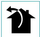
In questa versione, fumi e vapori vengono convogliati verso l'esterno attraverso il tubo di scarico. A tal fine, il raccordo d'uscita della cappa, deve essere collegato tramite un tubo, ad un'uscita esterna.
