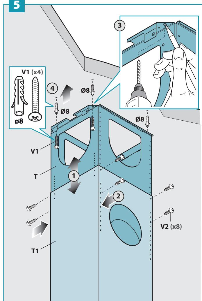
IT - Installazione su soffitto senza prolunga (H) e traliccio (T) (6). Montaggio valvola di non ritorno (7); tubo aspirazione (8); assemblaggio camino (9).
