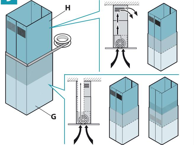
IT - Configurazione a soffitto (10); configurazione a controsoffitto 11.
