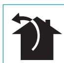
U ovoj verziji plinovi i pare su ispušteni vani kroz ispušnu cijev. Radi toga, izlaz nape mora biti spojen putem cijevi na vanjski izlaz.
