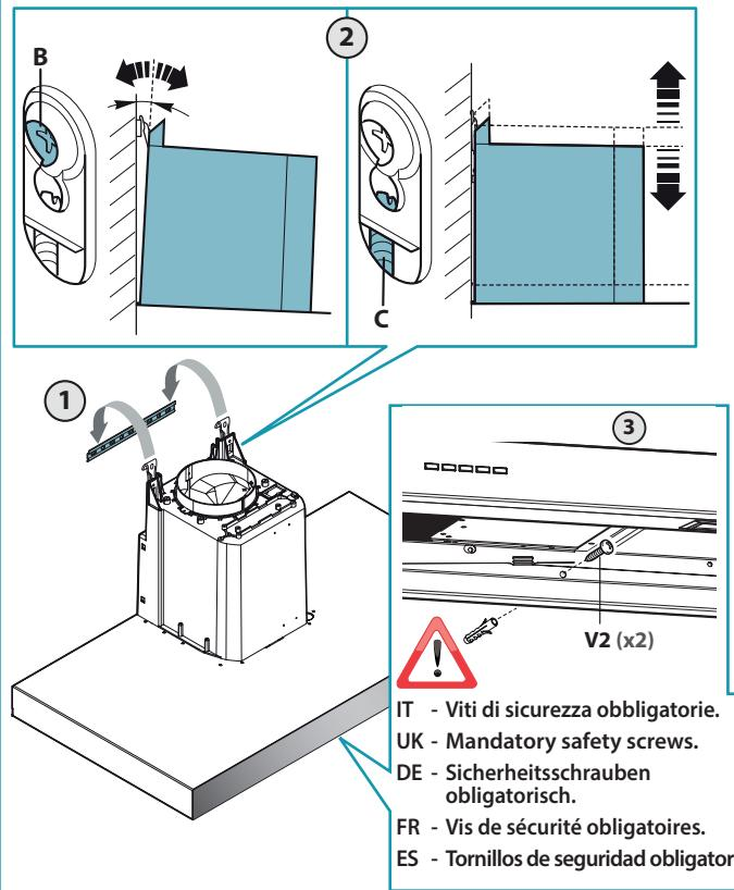
**IT** - Fissaggio cappa (1), installazione valvola di non ritorno (2) e montaggio tubo d'aspirazione (3).
