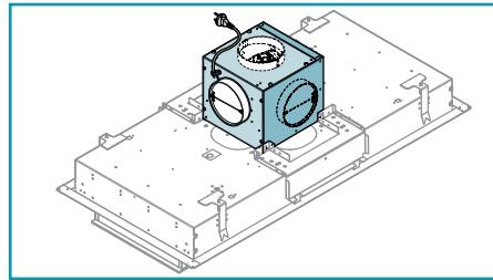
**SE** - Avlägsna flänsset från fläkthuven (1) och motor (2). Om luftutloppet är uppåt, se (3). För andra riktningar, se (4) och (5).
