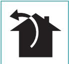
På denne version ledes røg og dampe fra køkkenet ud i det fri gennem et udledningsrør. Til dette formål skal udgangen på emhætten være forbundet til et eksternt udtag via en rørføring.
