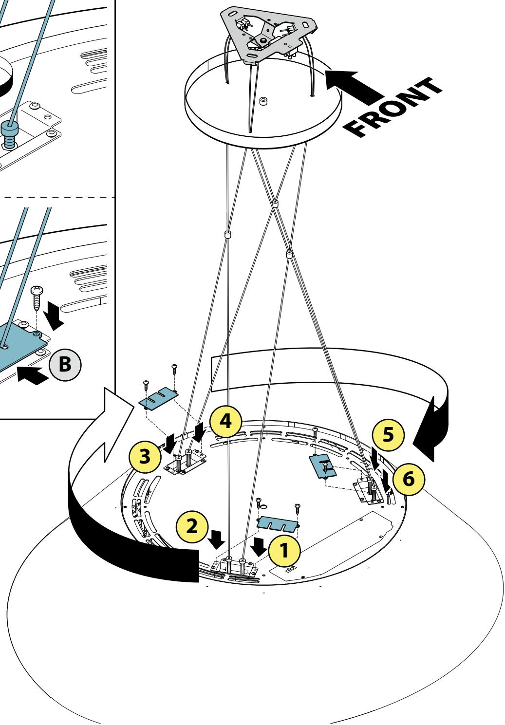
IT - Collegamento elettrico e fissaggio coperchio di chiusura (7).
