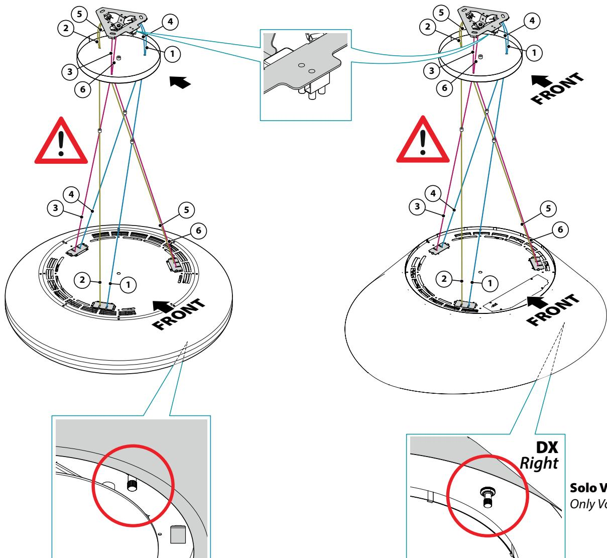
IT - Bloccaggio cavi di sostegno (6).
