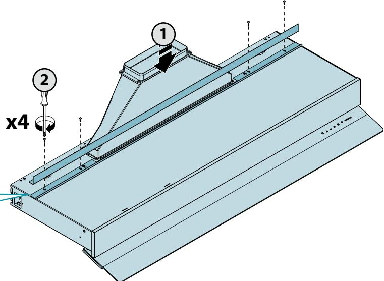
**IT** - Posizionare la cappa nella barra di montaggio (6). Allineare i fori del coperchio con i fori della barra di montaggio. Regolare l'inclinazione della cappa agendo sui grani di regolazione con una chiave a brugola (7).
