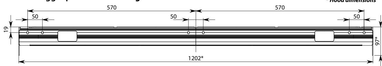
**IT** - Misure per l'installazione (1). Togliere le viti indicate. Estrarre la barra di montaggio (2). Fissare con i tasselli la barra di montaggio al muro (3).
