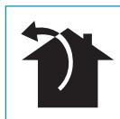
En esta versión, los humos y vapores son canalizados hacia el ambiente exterior a través del tubo de descarga. Para ello, el racor de salida de la campana debe conectarse mediante un tubo, a una salida externa.
